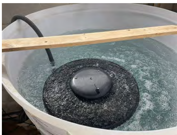
Imagen nº 3: Depósito aireación para elaboración té de compost.
