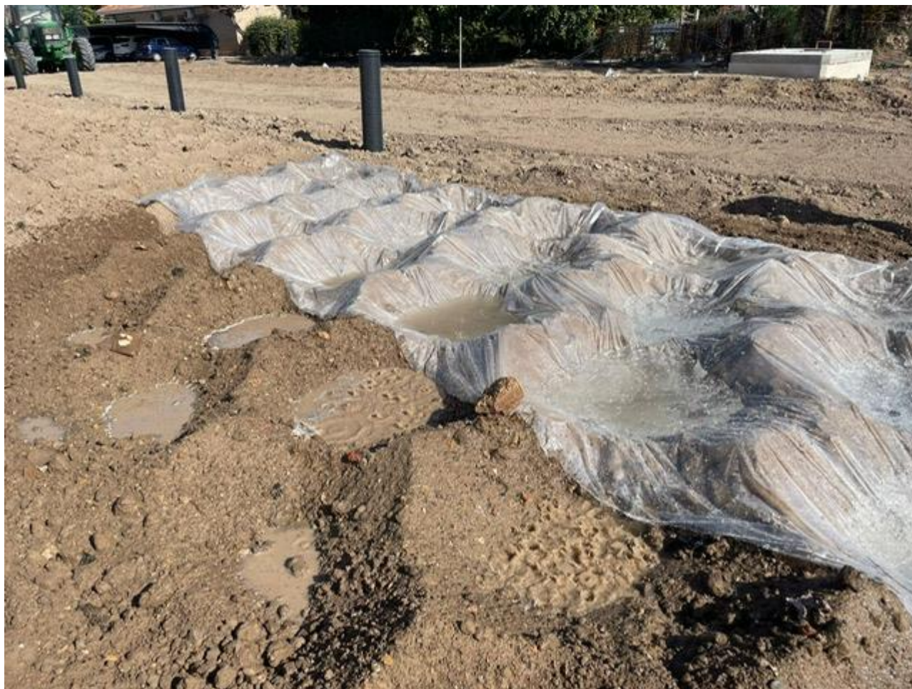
Imagen nº 4. Detalle cálculo experimental del volumen de agua que retiene el aserpiado.
