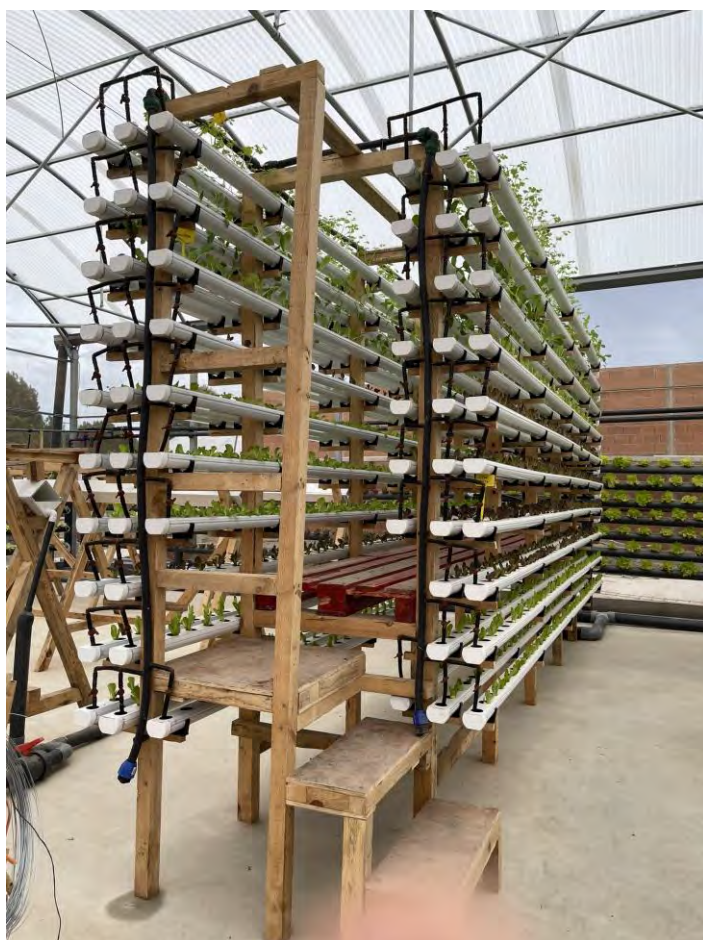
Imagen 7. Muro, sistema vertical canales NFT
