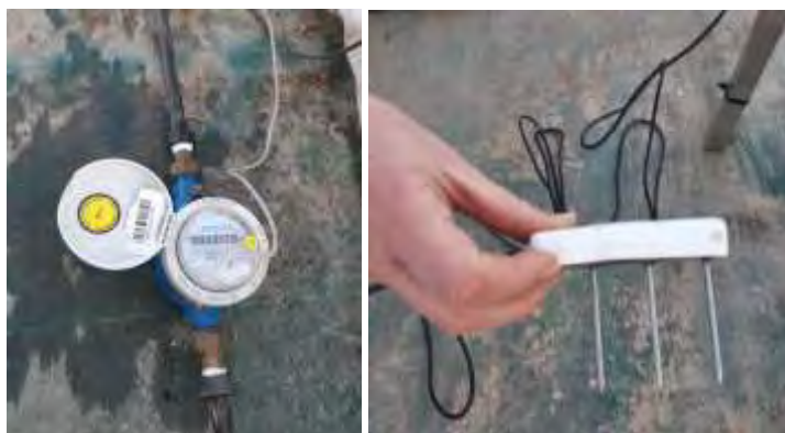
Caudalímetro para tubería portagoteros y sensor para saco de fibra de coco.
