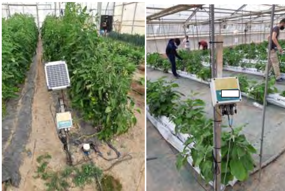
Aspecto de los dispositivos de control de humedad en el suelo. Foto 1 febrero de 2021.
